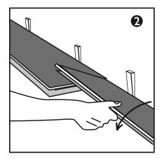
Setzen Sie die neue Diele bündig an die Stirnseite der zuvor verlegten Diele und drücken Sie diese senkrecht ein.
