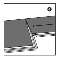
Setzen Sie die neue Diele längsseitig schräg an und achten Sie dabei bitte darauf, dass die Diele stirnseitig passgenau anliegt.
