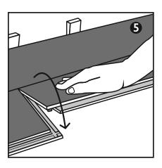
Klopfen Sie die Diele mit dem Schlagholz vorsichtig in das Längsprofil bis die Fuge geschlossen ist. Dabei achten Sie darauf, dass die Stirnseite bündig anliegt.
