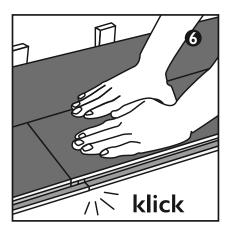
Durch den Druck auf die Diele rastet diese mit einem Klick ein. Mit den folgenden Dielen weiter so verfahren.
